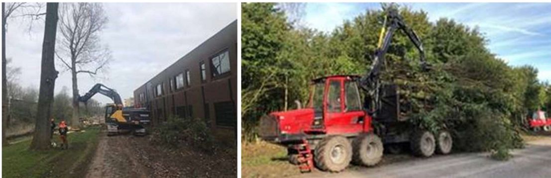
Figuur 4. Boomoogstwerkzaamheden in opdracht van RWS. Links: Kraan met grijpklauw (Volvo CE300) en kettingzaag gebruikt voor het vellen van bomen; Rechts: forwarder (Komatsu 865) voor het uitrijden van geveldde bomen (Foto's: Coos Aalbers, RWS).
